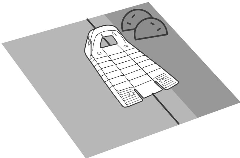
En cas d'**Installation externe**, la station doit être placée légèrement en retrait vers la droite afin de permettre à la tondeuse de pénétrer facilement dans la station.
