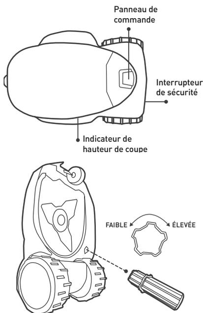
**Mettez toujours sur le commutateur de sécurité sur OFF avant de régler la hauteur de coupe !**
