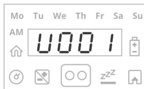
Positionnez la tondeuse à l'intérieur de la pelouse, à peu près 3 m devant la station, face au câble périphérique et appuyez sur OK pour commencer le test.
