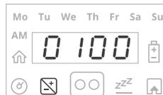
Utilisez les flèches de défilement pour régler le temps de tonte affecté (en %) et appuyez sur **OK** pour confirmer.
