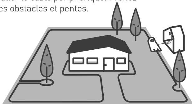
Tirez environ 30 cm de câble par le trou du cache en plastique de la bobine et fixez le début du câble au sol avec un piquet à l'endroit où vous prévoyez d'installer la station.
