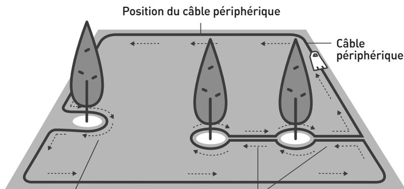
Si la distance entre un îlot et le câble périphérique est inférieure à 1 m, intégrez l'obstacle à la bordure de la pelouse.
