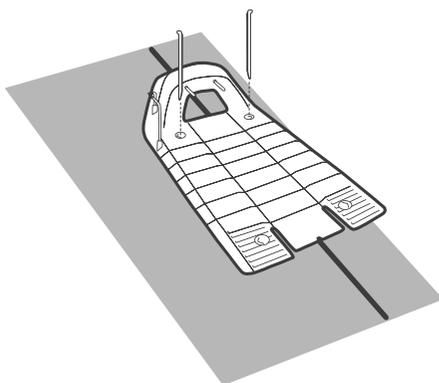
**Prenez soin de ne pas endommager de canalisation d'eau en enfonçant les piquets avec le marteau.**
