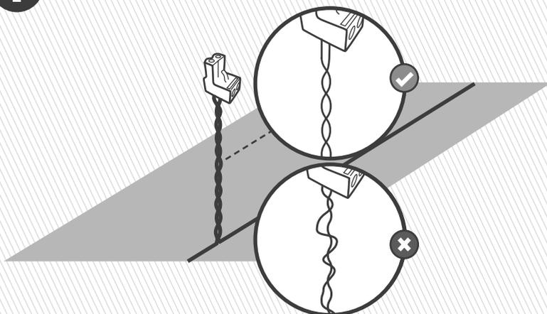
Dénudez l'extrémité des câbles sur 5 mm, insérez le câble torsadé dans le connecteur et fixez-le à l'aide d'un petit tournevis plat.
