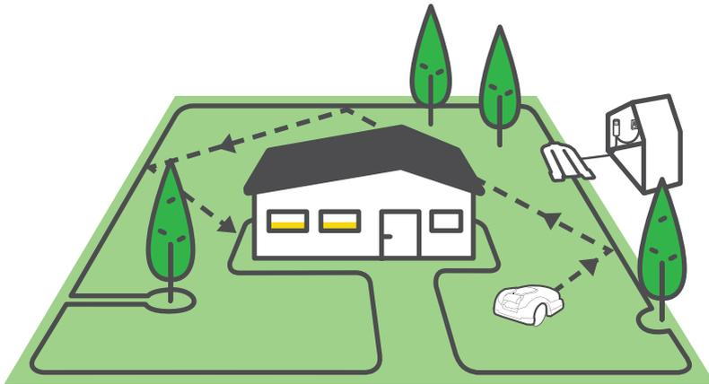
Der Mäher wird sich auf zufälliger Route (gemäß Vorgabe durch den Begrenzungsdraht) innerhalb seiner Arbeitszone bewegen. Durch die zufällige Route erhält der Rasen einen perfekten und lückenlosen Schnitt.
